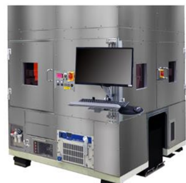
写真1. マイクロ LED ディスプレイ 転写装置「RAP-LLO」
