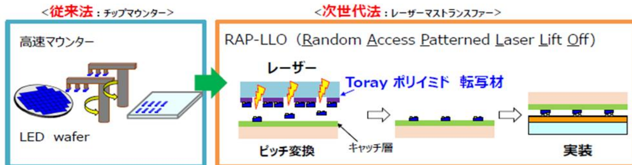
図2. 従来法とレーザーマストランスファー工程比較
