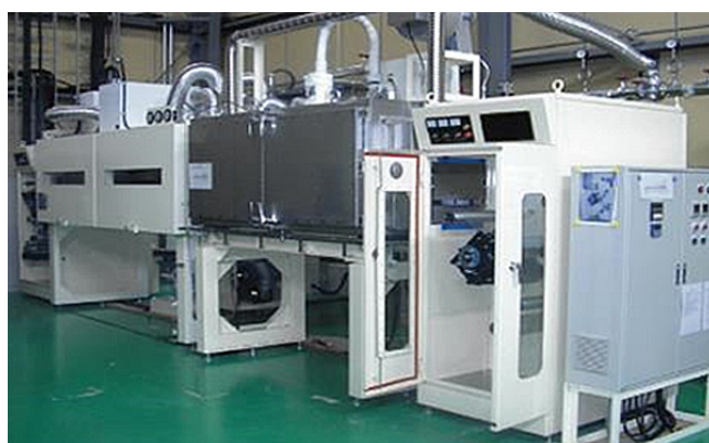
図1. 乾燥炉に過熱水蒸気炉を採用した R-to-R 塗工装置
