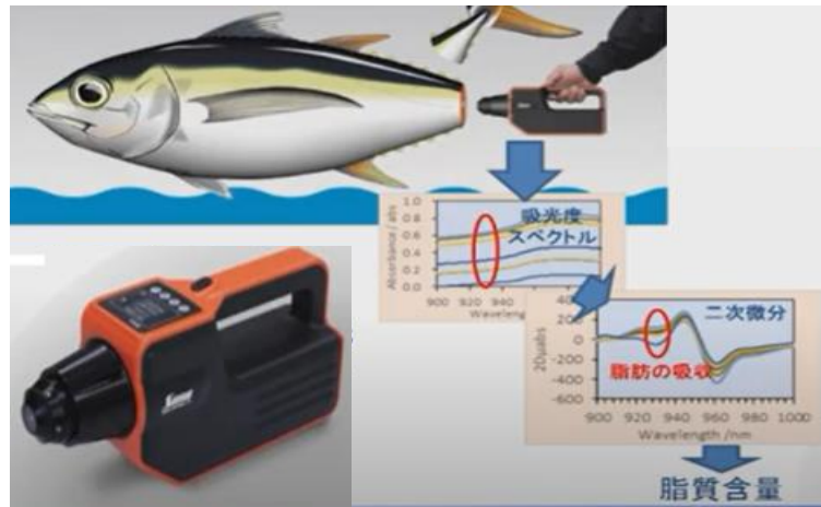
図2. 近赤外マグロ脂質測定装置の原理
