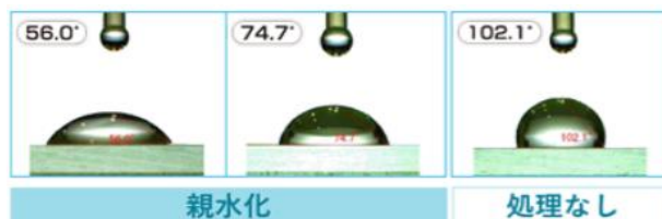
図 6. PTFE フィルムの親水化処理例
