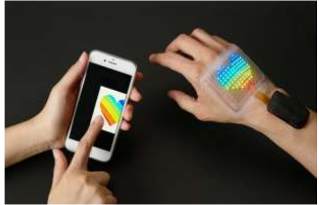
写真2. 表示部と、駆動回路、BLE通信回路、電源を一体化して皮膚に貼り付けられたフルカラースキンディスプレイ。
