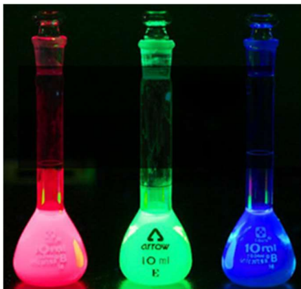
図1. ペロブスカイト量子ドットの各種蛍光インク
